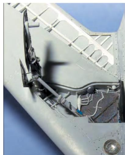
Die Bremsklappen wurden aufgeschnitten und die Tragflächeninnenseite mit Strukturen versehen. Unten im Bild: der Landescheinwerfer
