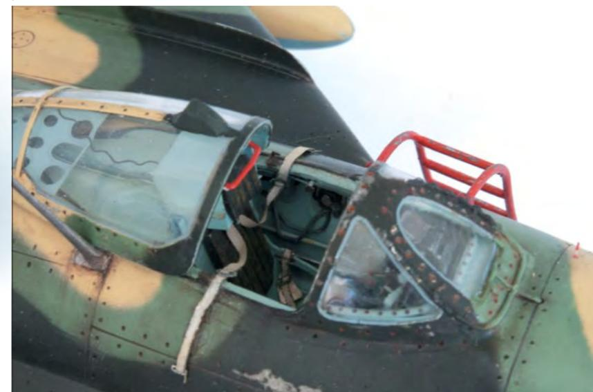
Die Frontscheibe wurde durch eine aus „Panzerglas“ ersetzt und um das Regenabweisesystem ergänzt.
