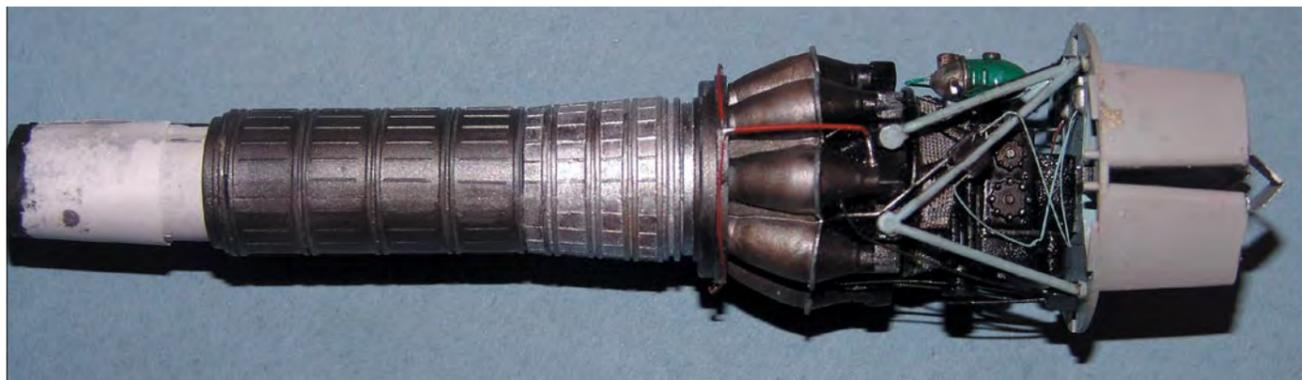
Das Triebwerk VK-1F vor dem Einbau. Ein Papierröllchen sorgt für die Verbindung zur Nachbrennersektion.
