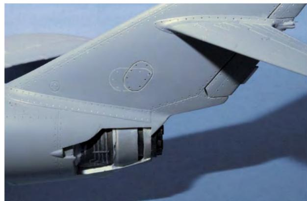
Blick auf das neue „gun blast panel“ und den vertieften Bugradschacht.
